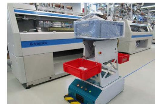
Das Fahrerlose Transportsystem (FTS) LEO Locative fährt im Neubau die Ware von einer zur nächsten Produktionsstation.
