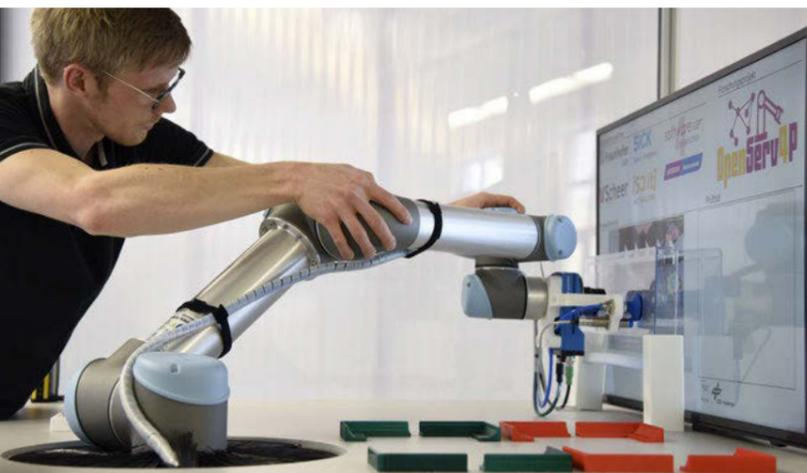
Automatisierte Qualitätssicherung: Die Kamera am Roboter überprüft die Qualität des Kunststoffbauteils auf Beschädigungen wie Kratzer, Lufteinschlüsse oder Schlieren. Erlern wurde die Bilderkennung auf Basis von Bildern fehlerhafter Bauteile. Um aus wenigen vorhandenen Bildern eine große Menge an Trainingsdaten zu generieren, wurden diese z. B. durch Vergrößern, Drehen und Verschieben künstlich erweitert (Data Augmentation).
