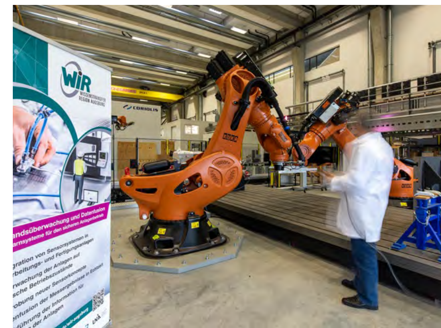
Im Projekt „WiR“ der Universität Augsburg wird in einem Innovationslabor ein robotergestützter Komponentenprüfstand aufgebaut. Die Flexibilität der Roboter erlaubt das Aufbringen realitätsnaher, komplexer Lastfälle. Bild: Regio Augsburg Wirtschaft GmbH/ Fotograf Stefan Mayr
